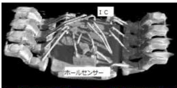
ホールセンサーとICの混載パッケージ
