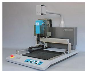
基板などのEMIに加え、電磁波照射プローブによるEMS評価が可能。
