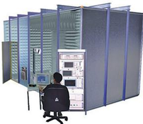
アンテナやモバイル機器などの空間電波特性を3-Dの放射パターンで測定可能。
